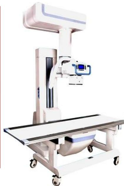
**计算机X线成像术 (computed radiography, CR)** 是将X线照射的影像信息记录在影像板 (image plate, IP) 上, 经读取装置读取, 由计算机计算出一个数字化图像, 复经数字/模拟转换器转换, 于荧屏上显示出灰阶图像。
