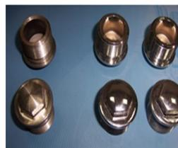
图7 复合冷挤压件
